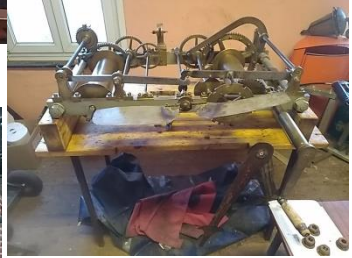
Nettoyage du mécanisme d'origine de l'horloge pour pouvoir l'exposer dans l'église.
