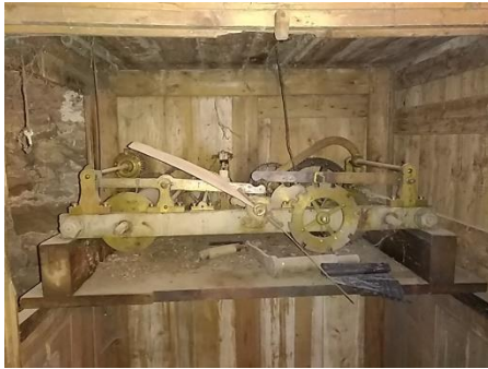
L'horloge monumentale a été nettoyée et repeinte par Jean-Charles Rollet et Marc Boutet, de nouvelles aiguilles et quatre nouvelles minuteries ont été installées.
